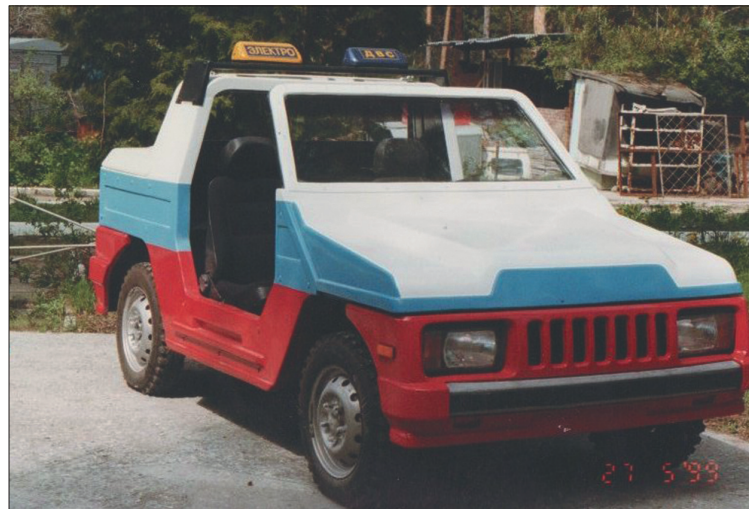
■ Прототип лёгкого коррозионно-стойкого внедорожника с трансформируемым кузовом
